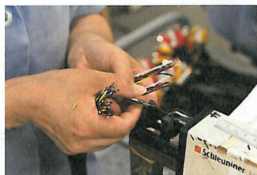
上:ハーネスの製造は手で作業する部分も多い 右:ウェブの受注を担当している生産管理部門。工場の在庫状況などがダイレクトにわかるため、スピーディな対応ができる
